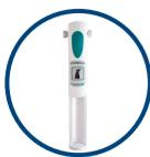
Mit der Knopfdruckbedienung verdünnen Sie Chemikalienkonzentrate automatisch, z.B. für Sprayer, Eimer, Waschbecken, Scheuersaugmaschinen und Behälterschaumgeräte. Durch Austauschen von einzelnen Düsen kann die Konzentration eingestellt werden. Mittels Drücken des grünen Knopfes wird über den Wasserdurchfluss die Chemikalie angesaugt und mit dem Wasser vermischt. Erhältlich in vier Ausführungen, die entweder ein, zwei, drei oder vier verschiedene Reinigungs- bzw. Desinfektionslösungen herstellen.
